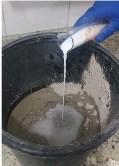
Figura 6 – Preparo da calda com a adição de ADI-CRIL S28 (a) e consistência final da calda (b).
